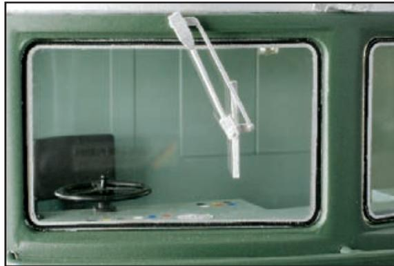
Die Lokfront gefällt durch feine Details und gute Lösungen: die Schläuche sind aus Gummi und feinem Spiraldraht gefertigt. Etwas flach wirken nur die Gravuren der Laufstege auf dem Dach, jene der Lüftergitter hingegen sind sauber ausgeführt.
